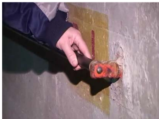
Рисунок 4 – Пример измерения длин отрезков в плотине трехметровым углепластиковым жезлом
