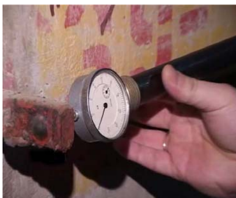
Рисунок 4 – Пример измерения длин отрезков в плотине трехметровым углепластиковым жезлом
